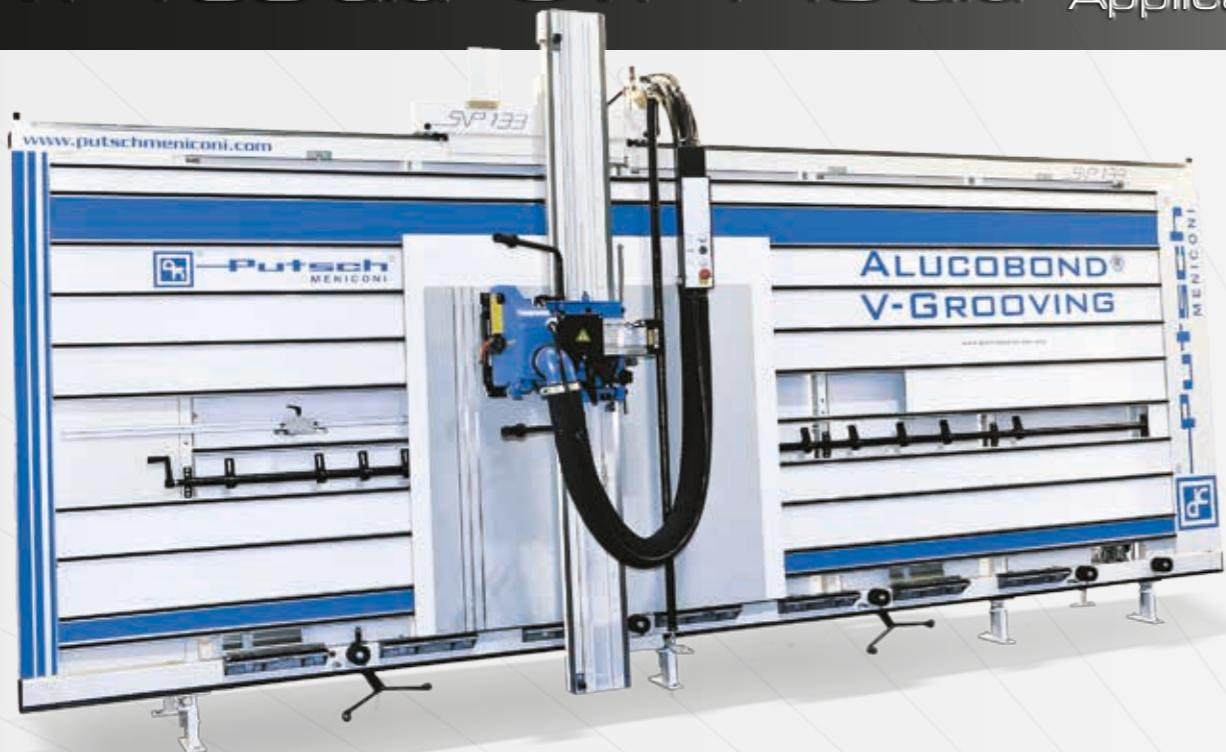
Fresature su pannelli compositi del tipo sandwich, ACM (Alucobond®, etc.) e superfici solide (Corian®, etc.)
